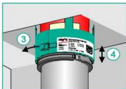
3 Leg de manchets om de strook geluidsisolatiemateriaal en sluit hem met de sluitklem.
